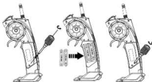
Извадете капака на батерията, разхлабвайки винта на гърба на предавателя с включена отвертка. Инсталрайте 2x 1,5 AA батерии (не са включени) в правилни полярности. Затворете капака на батерията и затегнете винта. Забележка: Когато инсталрайте батерии, проверете дали съответстват на полярностите, отбелзани на държача на батерията. Не смесвайте новите и старите батерии. Не смесвайте различни видове батерии.
